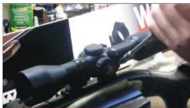
20 – Utilizamos un destornillador dinámico con un par de apriete de 2,4 nm para apretar los tornillos de unión de la parte superior e inferior de las anillas. Seguimos una técnica en zig-zag o en X.
