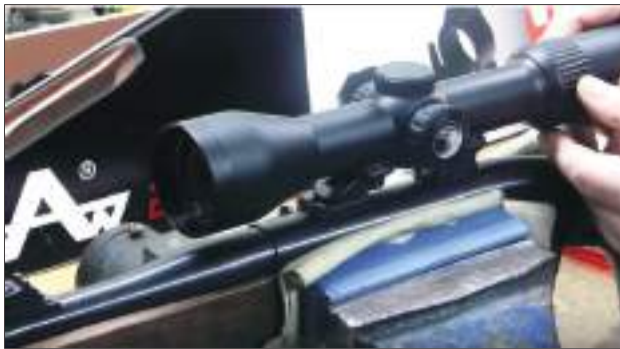
14 – Colocamos el visor en una distancia de la culata que dependerá de la estatura y morfología del tirador al que vaya destinado.
