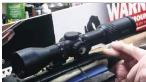
23 – Con dos llaves allen manipulamos la posición del pestillo de seguridad, soltando el prisionero que lo mantiene asegurado y apretándolo en una posición elevada. Posteriormente volvemos a apretar el prisionero para ajustar la nueva posición.
