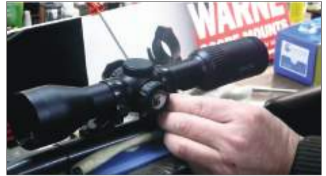
18 – Apretamos mínimamente los tornillos de unión de las anillas, siguiendo una técnica de apriete en X o zig-zag.
