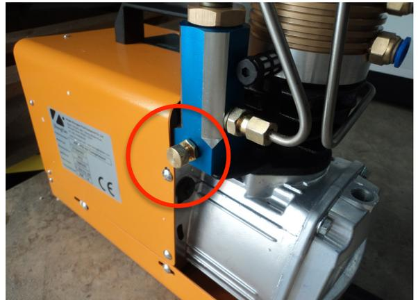
3.- Nunca ajustar más presión de la permitida a un depósito o carabina, es decir, si la carabina o depósito permite máximo 200 bares, configurar para llenado de 200 bares, nunca exceder de ese límite.
